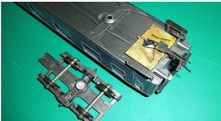
Das Dach wird wieder aufgeklipst mit die Faltenbälge und die Drehgestelle montiert, wobei die Kunststoff Räder durch Metall Räder ersetzt wurden.
