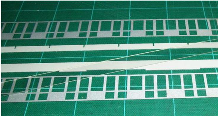
Die Abteil Längswand und die Bodenplatte sind ausgelasert in MDF 1.2 mm. und werden mit Spritzspachtel besprüht.
