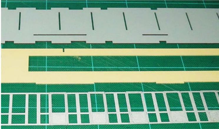
Auf eine Seite des Längswandes wird die Abteilstruktur geklebt. Von die Klarsicht Kunststoff Streife (Oben ins Bild) wird das Schützfoli abgezogen.
